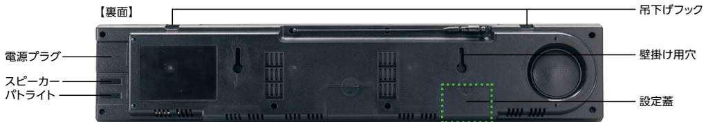
**吊下げフック** | 天井など、吊り下げて使用する際に使用します。
