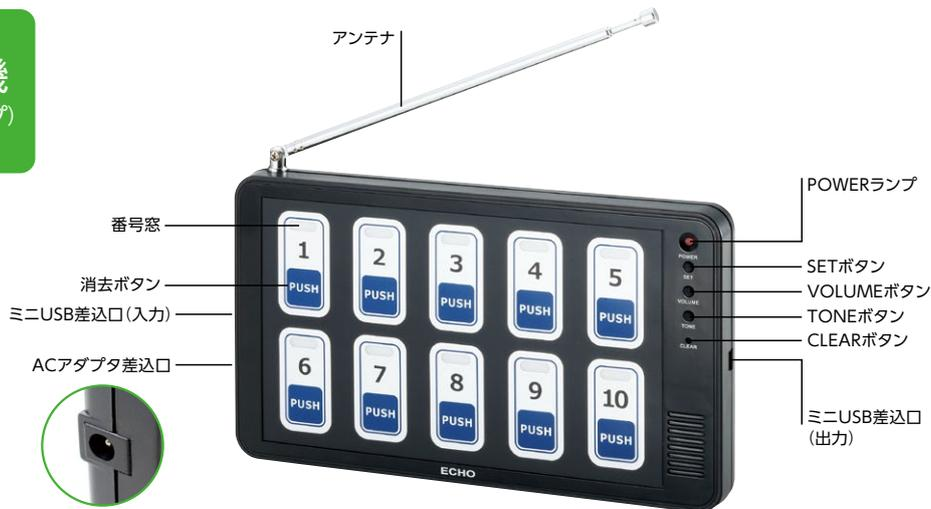
**POWERランプ** | 電源に接続されているときLEDが点灯します。
